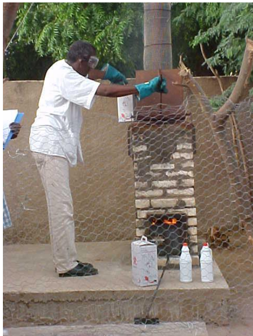
Incinération des boîtes de sécurité remplies (méthode la meilleure)
